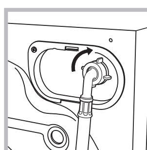
2. Collegare il tubo di alimentazione alla lavabiancheria avitandolo all'apposita presa d'acqua, nella parte posteriore in alto a destra (vedi figura).
